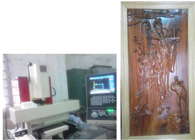
Hình 3: (Trái) Máy CNC được lắp tại phòng thí nghiệm của GS. Ngô Kiều Nhi với mức độ nội địa hóa hơn 80% - (Phải) Một tấm điêu khắc gỗ cổ được phục dựng bằng cách dùng máy CNC.
